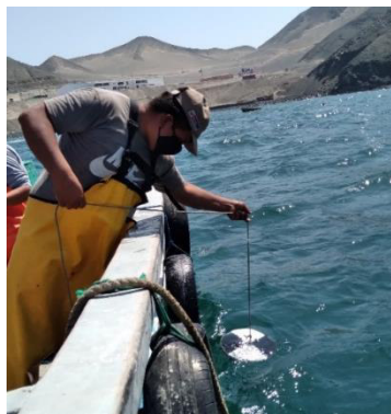
Figura 8. Medición de transparencia del agua uso del Disco Secchi
