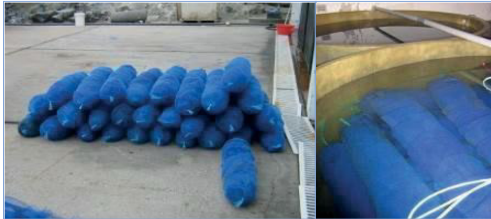
Figura 7. Sustrato netlon de fijación armado, tipo cono (izquierda). Formación del "biofilm" (derecha).
