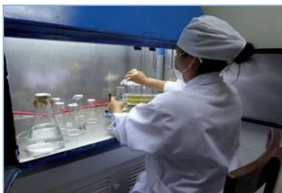
Figura 13. Siembra en cabina de inoculación a nivel inicial (125 ml)
