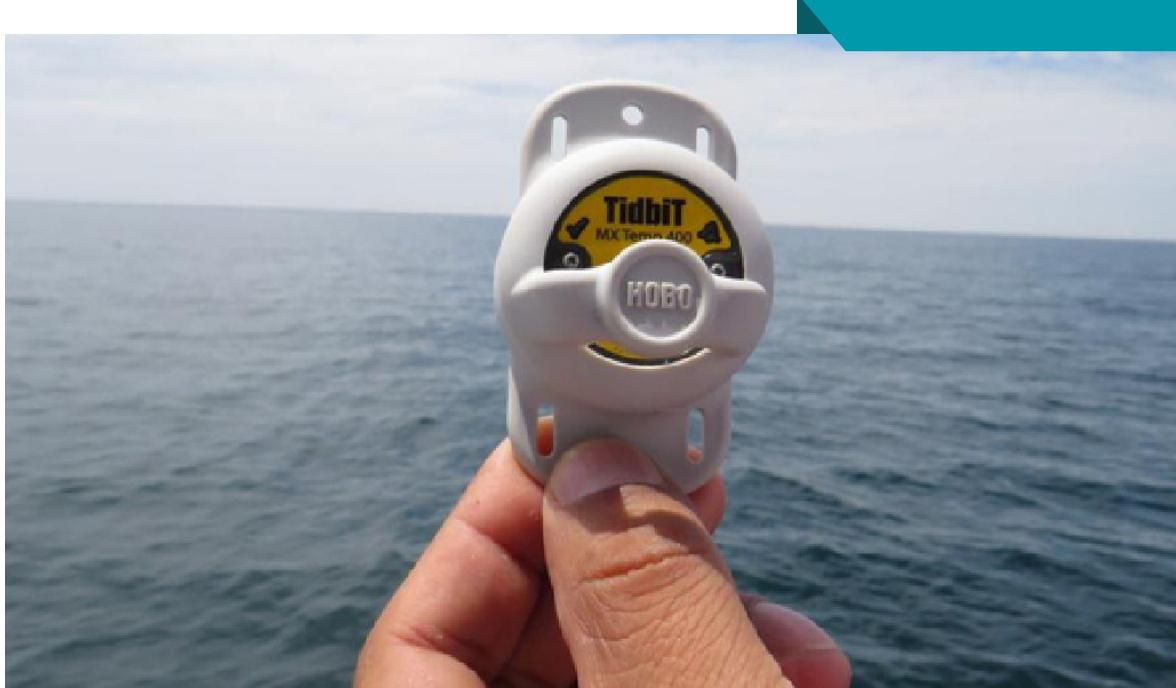
*Este moderno dispositivo medirá la temperatura superficial del agua de manera permanente en intervalos de 1 hora, durante las 24 horas, los 365 días del año*
