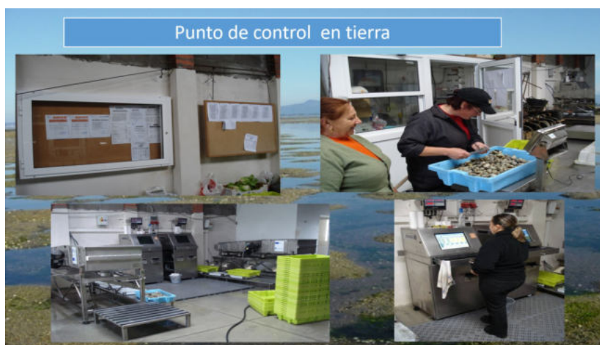
Figura 7: Tablones de anuncio, para informar sobre días de captura, cupos, otras labores....; control manual de lotes; tamizadoras automáticas de clasificación; computadores de control de las tamizadoras e impresión del justificante de paso de control.
