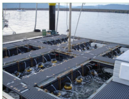
Figura 4: Esquema de un flupsy (cesarjungharada.com); contenedor para el sistema de "air-lift"; fondo perforado del contenedor "air-lift"; artefacto (6.5 x 7 m), con sistema "air-lift".
