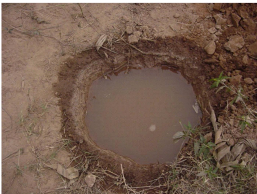
Foto N° 2. Momento de la lectura de la prueba del suelo por el método del hoyo.
