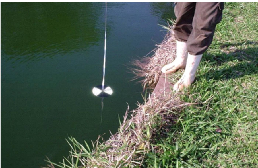
Foto n°4 Momento de la medición de la transparencia con el disco de secchi. La cuerda que sostiene el disco está graduada en centímetros y la turbidez es medida a la profundidad en que ya no es posible ver el disco (profundidad de extinción de la luz).
