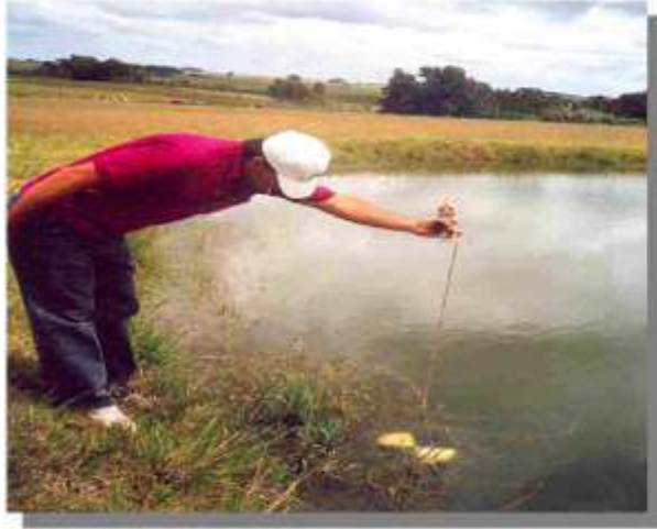
Foto 3. Medición de la transparencia del agua con disco de Secchi
