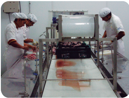
Foto N° 29. Superficie de trabajo construido de material de fácil limpieza (acero inoxidable).
