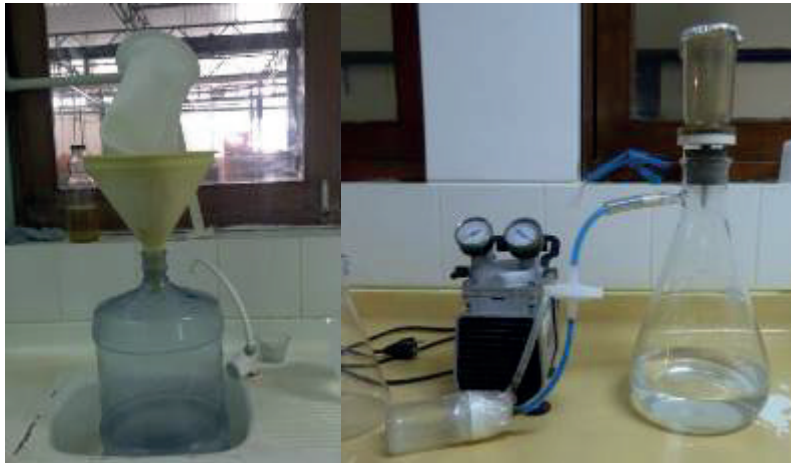
Figura N°34. Tratamiento al agua de mar. Filtrado a 1 micra (der.). Filtrado a 0,45 micras (izq.)
