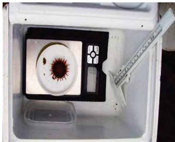
Figura 39.- Registro de longitud de testa (izquierda) y peso total (derecha) de erizo confinado en sistema de cultivo de engorde
