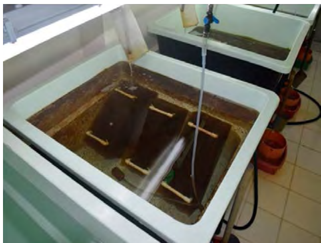
Figura 12.- Inyección de aire moderado en tanques con set de placas
