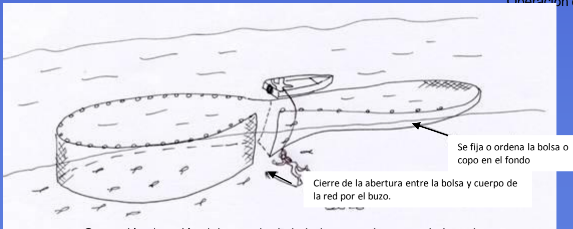
Operación de unión del cerrado de la bolsa con el cuerpo de la red
