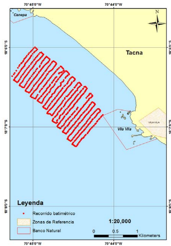
Figura 3: Recorrido durante el levantamiento batimétrico en la zona de Vila Vila.
