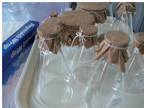
Figura 2: Material de vidrio limpio cubierto de papel aluminio y papel kraft.
