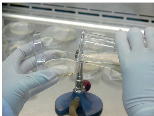
Figura 20: Dispensar el agar en placas de Petri.
