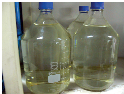
Figura 4: Almacenar el agua en botella de vidrio en oscuridad.
