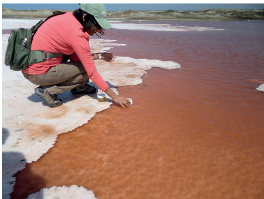
Figura 9: Toma de la muestra directamente con un frasco.
