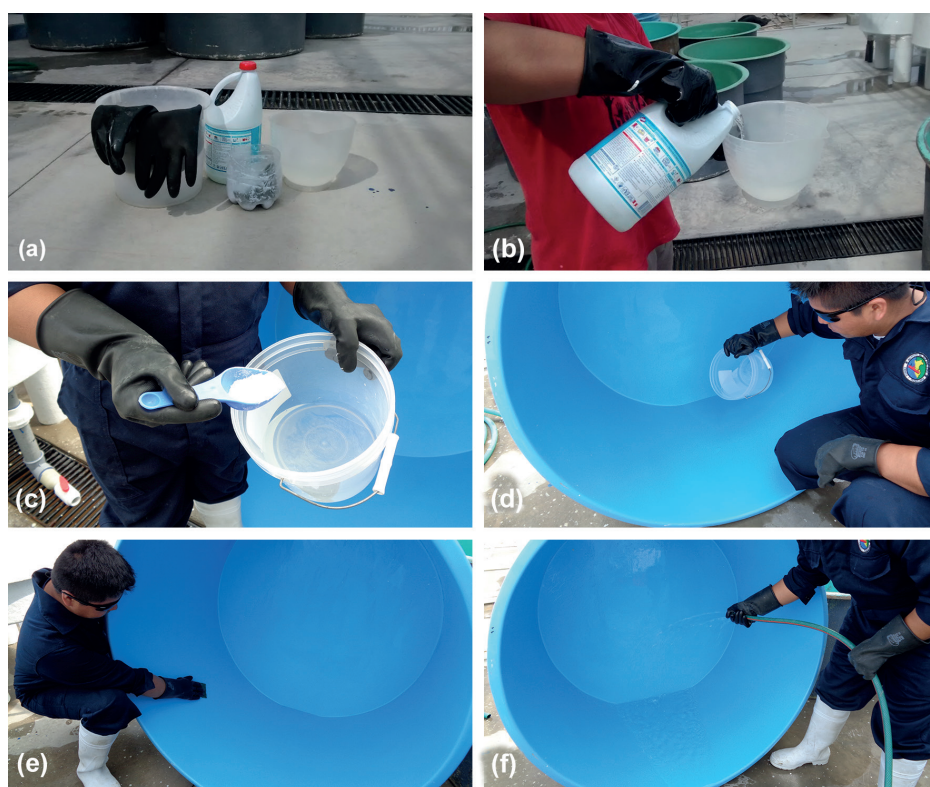
Figura 4. Implementación de tanques de cultivo. a) Material necesario para realizar lavado de tanques de fibra de vidrio; b) Dilución de hipoclorito de sodio; c) Incorporación de detergente granulado; d) Vertido de solución para lavado de tanque; e y f) Lavado y enjuague de tanque de fibra de vidrio.
