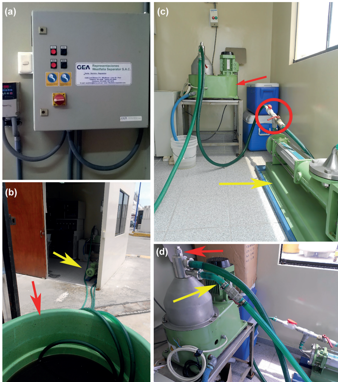
Figura 15. Proceso de centrifugación; a) A la derecha se ubica panel electrónico de la centrifuga y a la izquierda el variador de velocidad Allen Bardley ; b) Sistema de recirculación de cultivo, bomba de succión Nemo® (flecha roja), tanque de acopio de cultivo para centrifugación (flecha amarilla); c) Disposición final de sistema de centrifugación, ubicación de centrifuga de limpieza manual (flecha roja), ubicación de bomba de succión (flecha amarilla), posición final de llaves de paso de sistema de recirculación e ingreso de cultivo hacia centrifuga (círculo rojo); d) Posición final de mangueras de ingreso (flecha roja) y mangueras de salida después de centrifugación (flecha amarilla).
