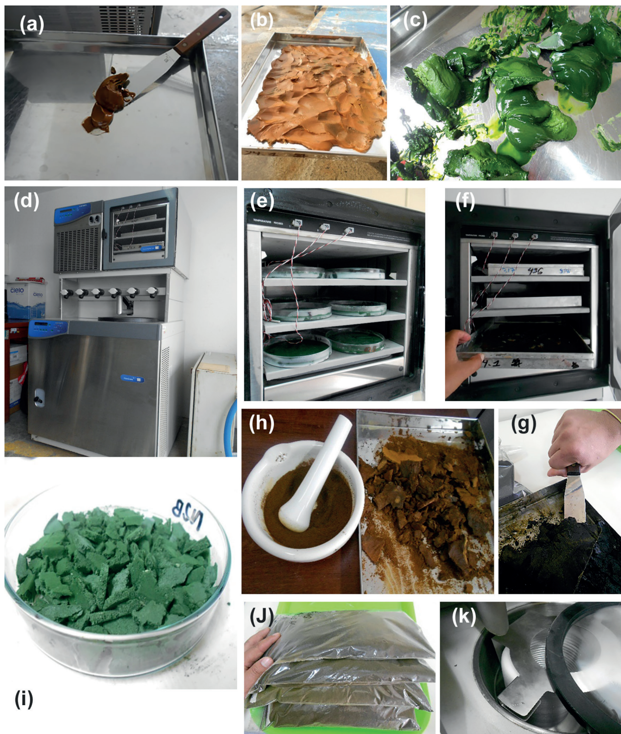
Figura 21. a) Biomasa microalgal esparciéndose en bandeja de acero inox.; b y c) Biomasa húmeda esparcida de 2 diferentes microalgas; d) Equipo realizando proceso de liofilización (flecha roja señala la posición final de llave central, indica que vacío se realiza en todo el equipo); e) Muestras en placas Petri de 150x25 mm; f y g) Muestras liofilizadas en bandejas de acero inox de 38 x36 x3 cm; h) Homogenización mecánica de muestras; i) Muestras liofilizadas en placas Petri de 150x25 mm; j) Muestras embolsadas y rotuladas para análisis o almacenamiento y k) Colector abierto para descongelamiento del agua que fue colectado durante el proceso de liofilización (Flecha roja señala el agua captada de las muestras en estado sólido).
