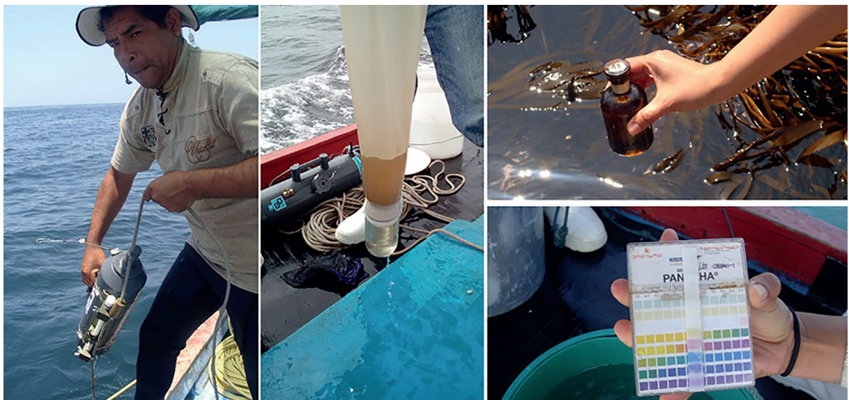
Figura 43. Colecta de muestras de agua para determinación de oxígeno disuelto (derecha superior), salinidad y temperatura con botella Niskin (izquierda), registro de pH (derecha inferior) y colecta de plancton (central)
