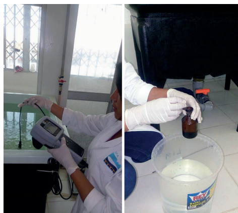
Figura 35. Registro de temperatura (izquierda) y toma de muestra de agua para determinación de oxígeno disuelto (derecha)
