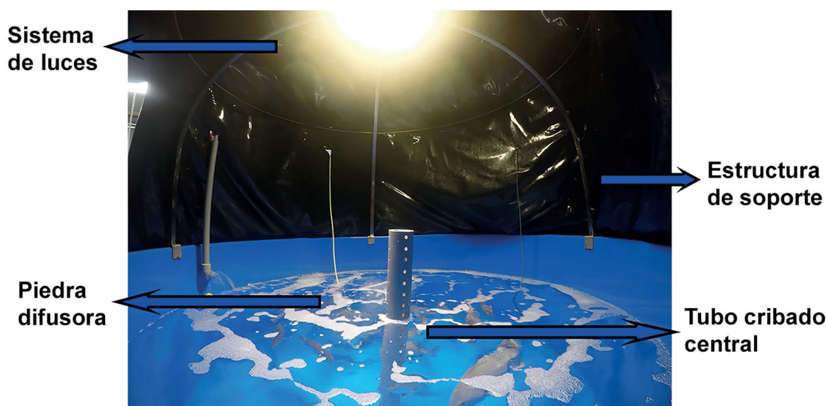
Figura 6. Parte interna del tanque de cultivo, presentando: estructura de soporte de acero inoxidable, tubo cribado central, piedra difusora y sistema de luces interior.
