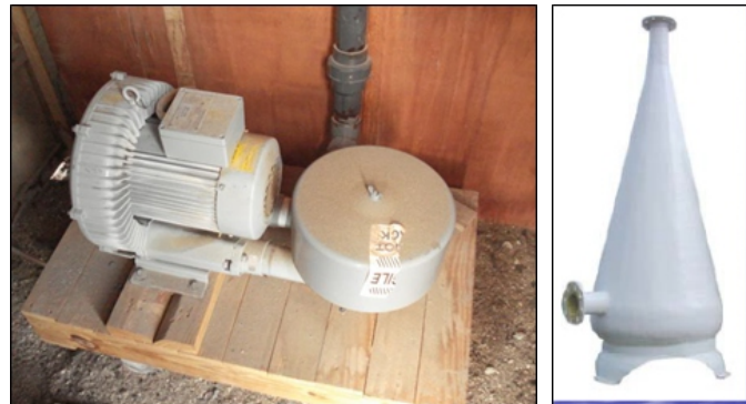
Fig. N° 24: Blower centrífuga y cono de sobresaturación
