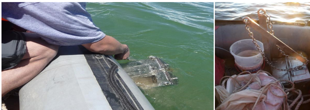
Figura 6: Muestreador de sedimentos en los puntos R-D y C-D. Fuente propia
