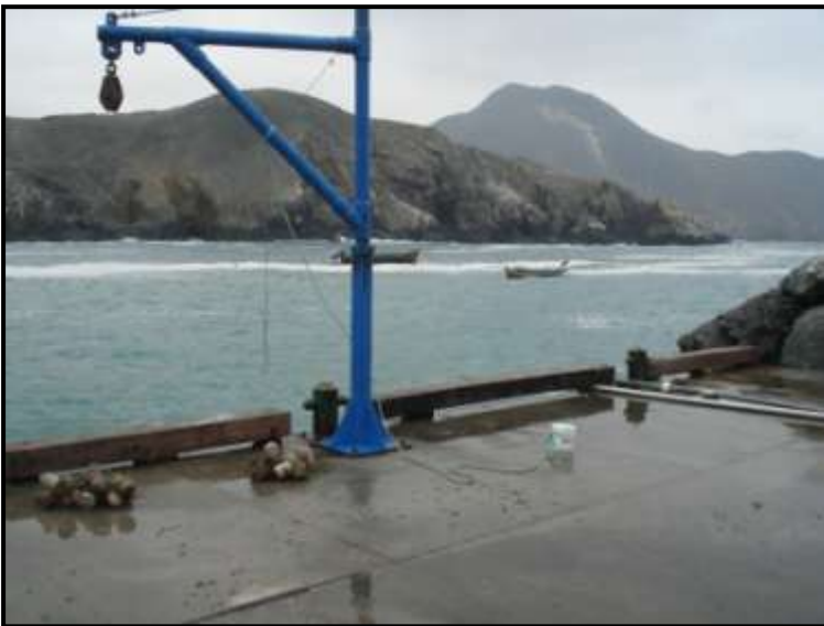
Pescante usado para embarque y desembarque
