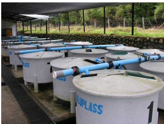
Figura 3. Tipo de estanques recomendados para la aplicación de fotoperiodos comprimidos para la reproducción de trucha arcoiris.
