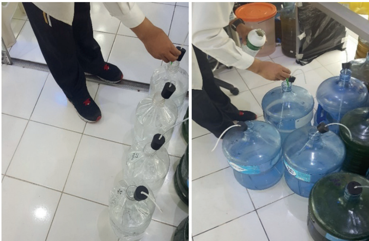
Figura 6: Adición de nutriente bayfoland al agua previamente tratada con hipoclorito de sodio y tiosulfato.
