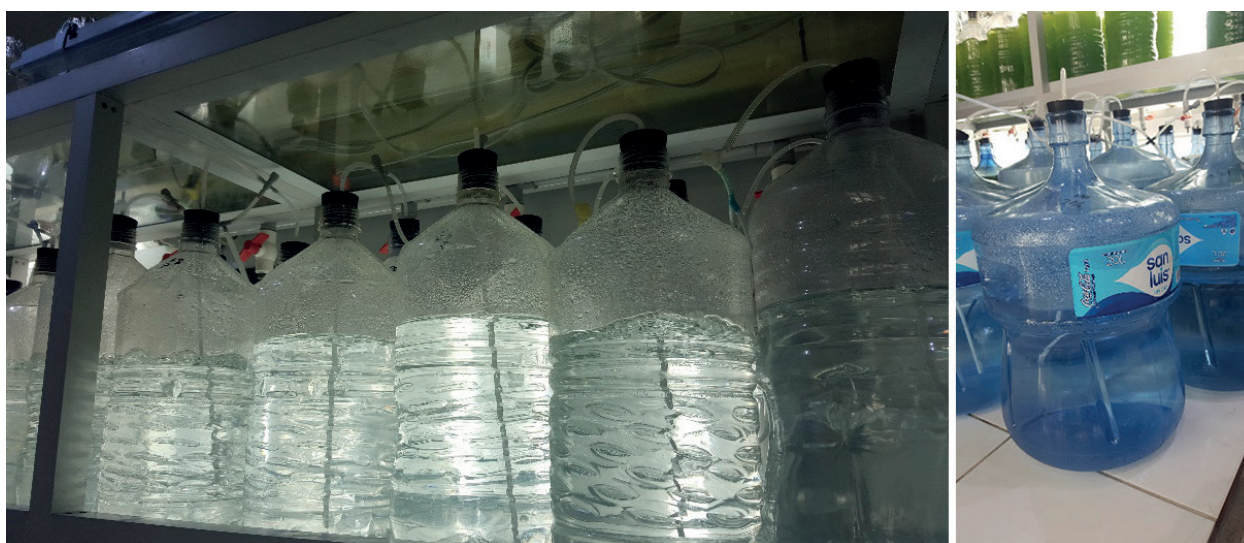
Figura 3: Tratamiento del agua de mar con hipoclorito de sodio y tiosulfato de sodio mantenidos bajo aireación constante.
