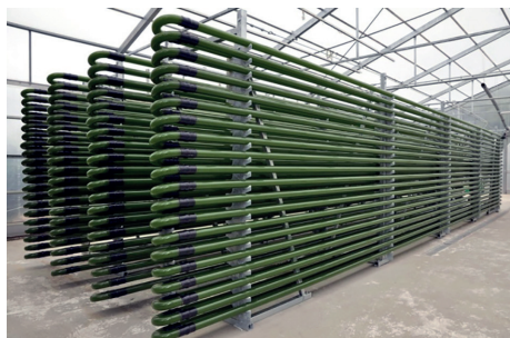
Figura 1. Sistemas de cultivos cerrados; i) Biorreactor tubular horizontal; ii) Biorreactor tubular vertical.
