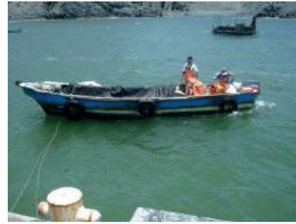
Fig. N° 31: Embarcación de fibra 22 de eslora
