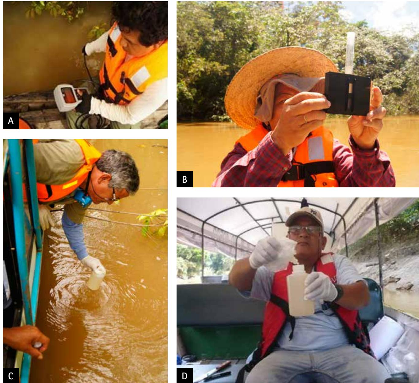
▲ FIGURA 1. A y B. Registro de parámetros físicos y químicos del agua, C y D = Colecta y conservación de agua para análisis de metales pesados.
